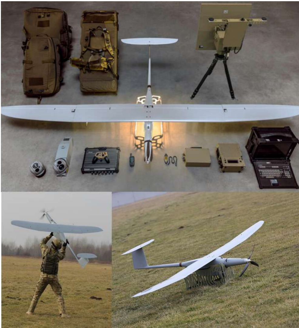
Rys. 18.4. Bezzałogowy statek powietrzny FlyEye (produkcji Grupy WB) wyposażony w heterogeniczny zasobnik wraz z wyposażeniem taktycznym
