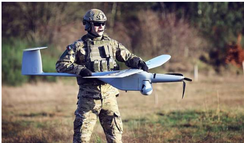
Rys. 18.3. Zasobnik heterogenicznej platformy UAV FlyEye (produkcji Grupy WB) z zabudowanym modułem radiowym oraz kamerą świtała dziennego i kamerą termowizyjną
