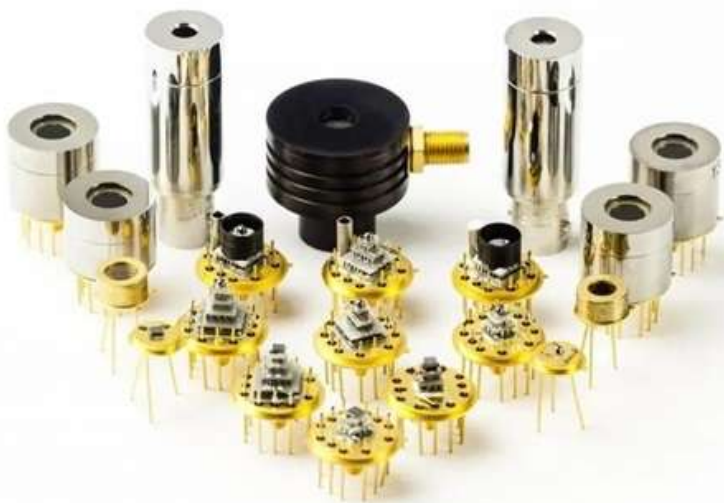
Rys. 26.7. Detektory podczerwieni opracowane przez firmę VIGO Photonics S.A.
